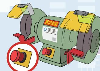
研磨機設有護罩及緊急停止裝置
