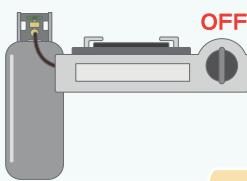
瓦斯更換後進行測漏，確認無洩漏現象
