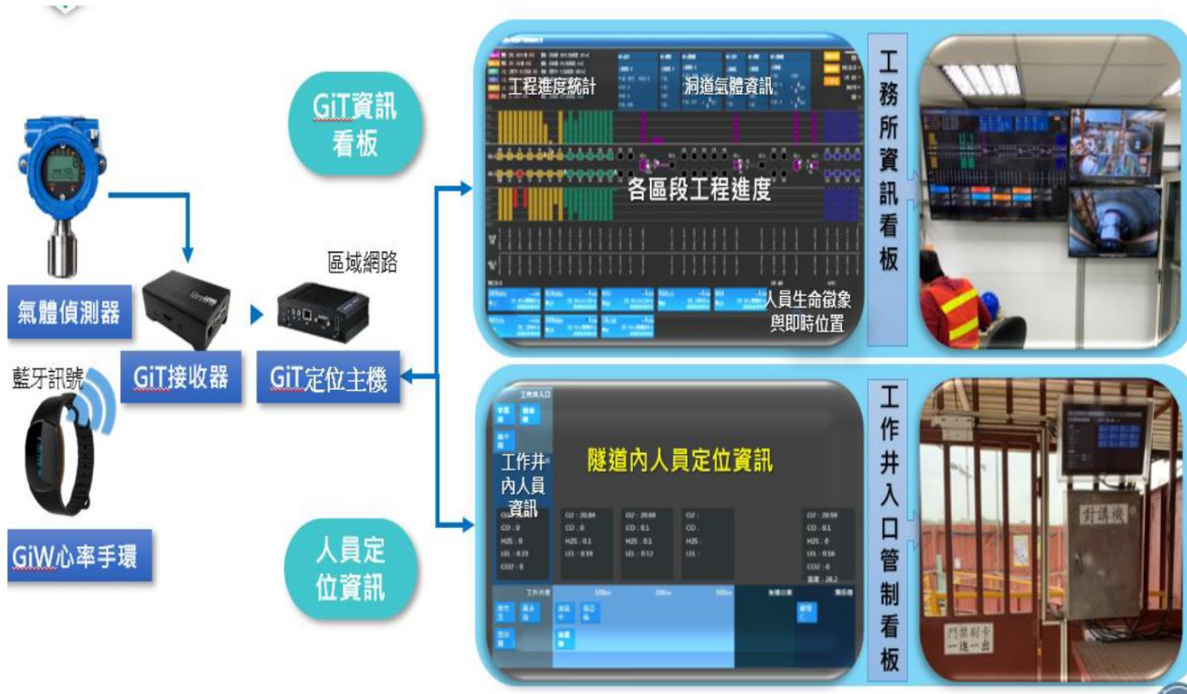
圖 29 潛盾作業局限空間即時定位與生命徵象監控系統應用
