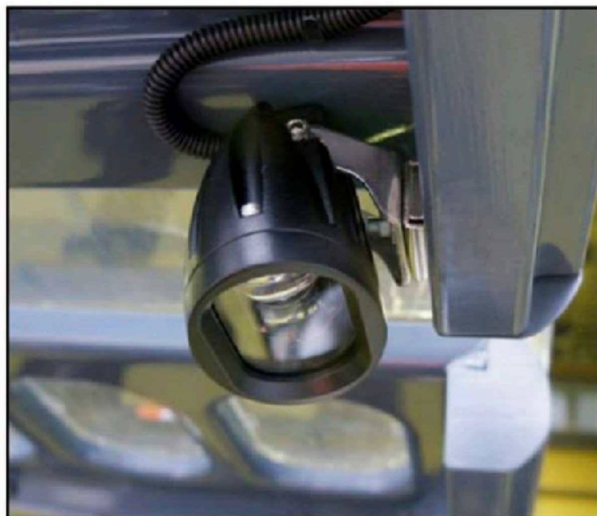
LED照明 取付状況
