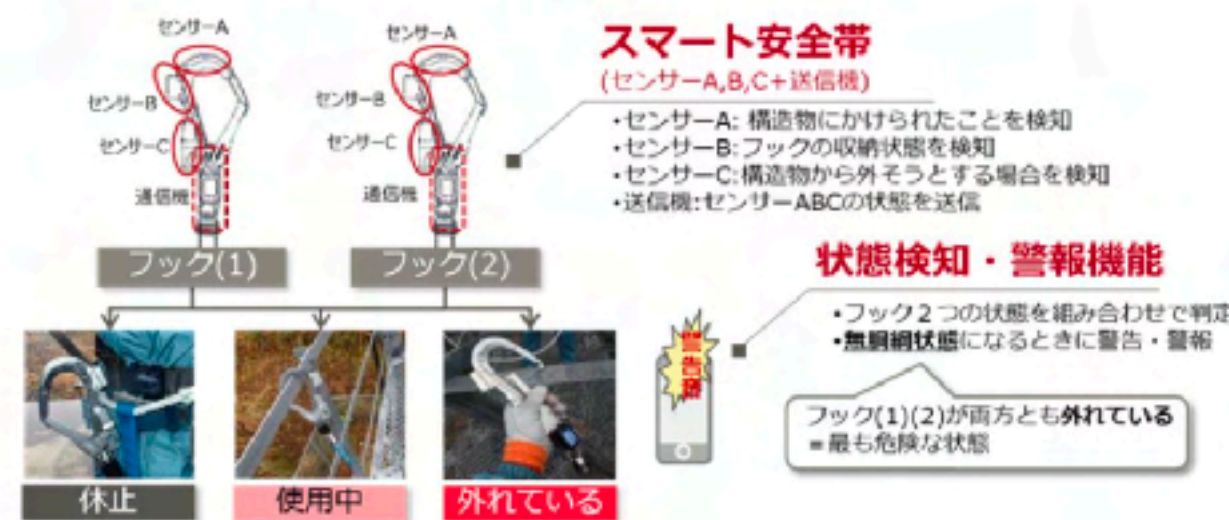
圖 2、智慧安全帶的感測器檢測原理 [1]
