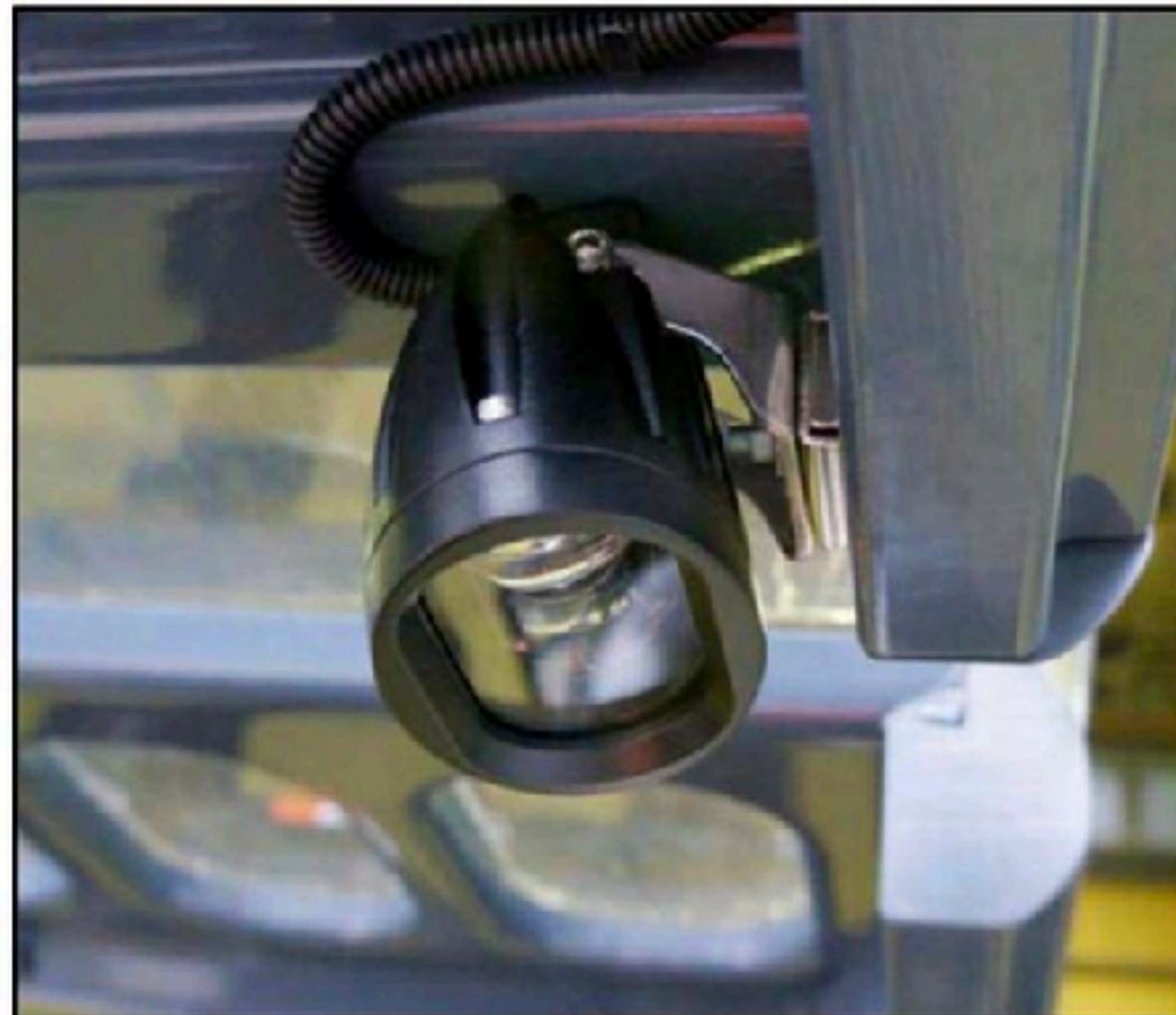
LED照明 取付状況
