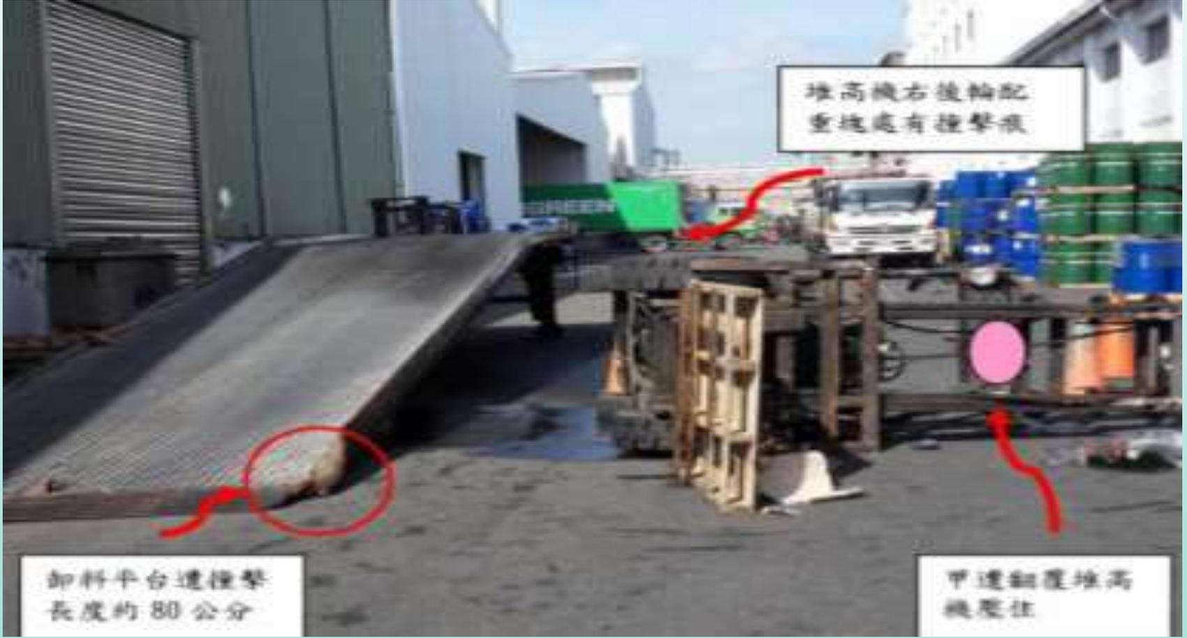
勞工甲駕駛堆高機從事搬運作業，後退時撞擊卸料平台斜坡導致重心不穩，造成堆高機翻覆壓死自己。
