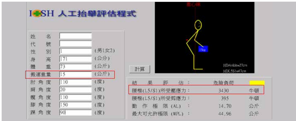
IOSH 人工抬舉搬運程式計算搬運醬油 (每箱 15 公斤) 之腰椎受力 3,430 牛頓 (N)
