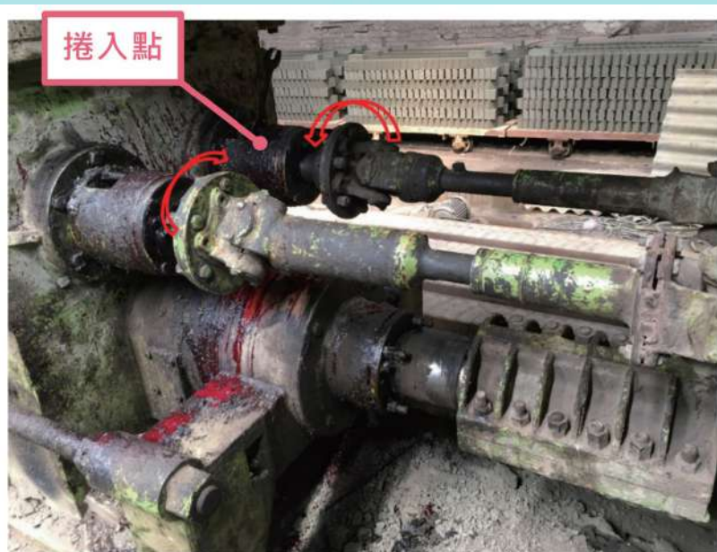
▲ 罹災者遭成型機運轉之傳動軸捲入。
