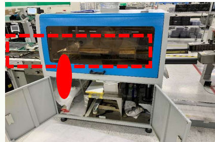
清潔結束未將護蓋蓋上進行測試
