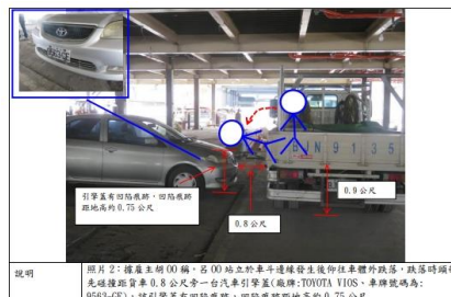
說明 照片1：發生災害之貨車(廠牌:BUWA 3000，車牌號碼為BUW-0135)，長為3.1公尺，寬為1.8公尺，車斗後欄板高度與鋼瓶高度為0.75公尺。呂OO站立於車斗上距地高約0.9公尺，裝於車斗上並未設置防止勞工跌落之安全設施。
