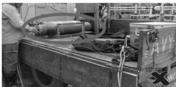
鋼瓶軟管破損
