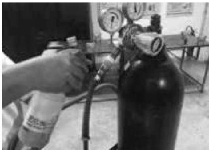
供氣系統的洩漏測試
