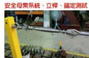
安全母索系統、立桿、錨定測試
