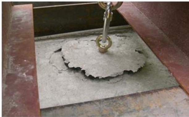
後裝膨脹式混凝土被扇形圓錐體破壞模式圖
