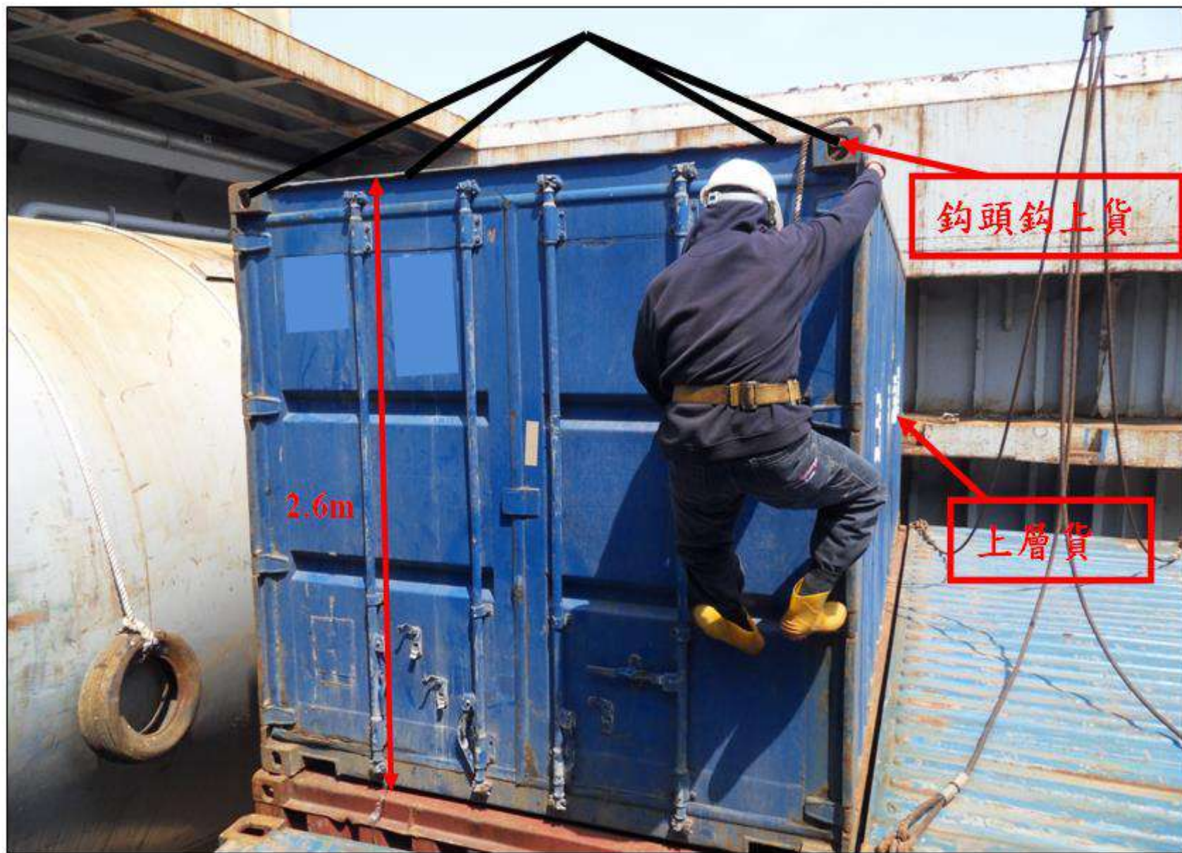
照片 1 罹災者在 上層貨櫃 將鉤頭鉤上貨櫃後，在無安全上下設備狀況下，由上層貨櫃門之鐵桿攀爬下來(示意圖)。
