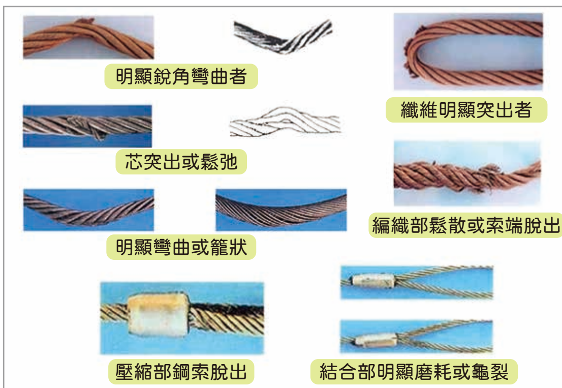
圖 8 鋼索損壞範例
