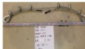
鋼索夾鎖鋼索之長邊示意图
