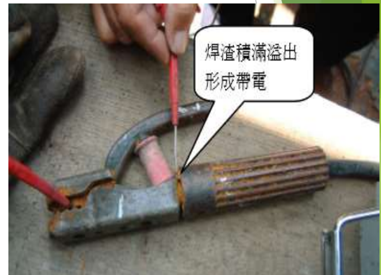
焊把前端積滿焊渣形成帶電
