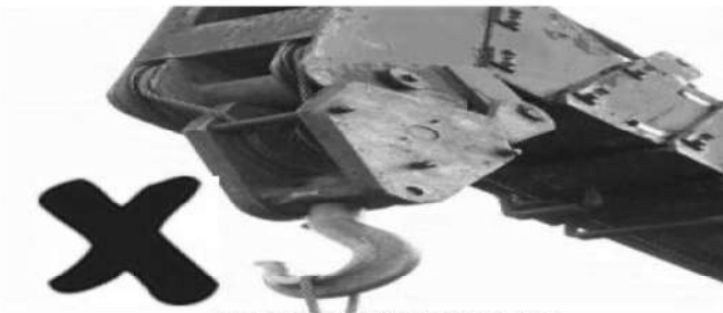
未安裝防滑舌片
