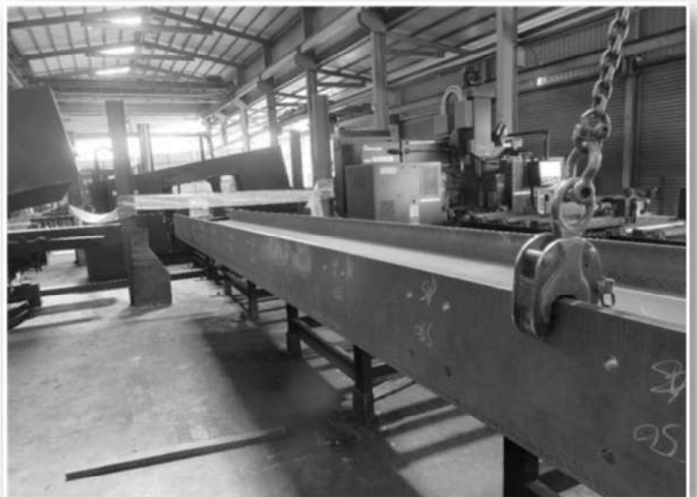
肇災固定式起重機使用吊鉗吊掛H型鋼，吊掛點在H型鋼中間部分。
