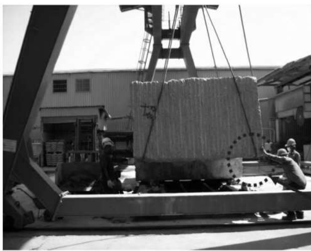
調整原石在切割用台車上之位置
