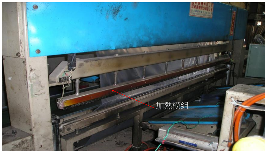
包裝機後緣之加熱模組漏電
