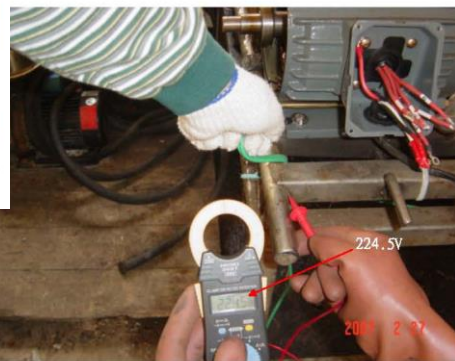
圖 12 馬達外殼有接地時，測量馬達外殼對遠處路燈燈桿（當作參考位準）間之電壓為 224.5V
