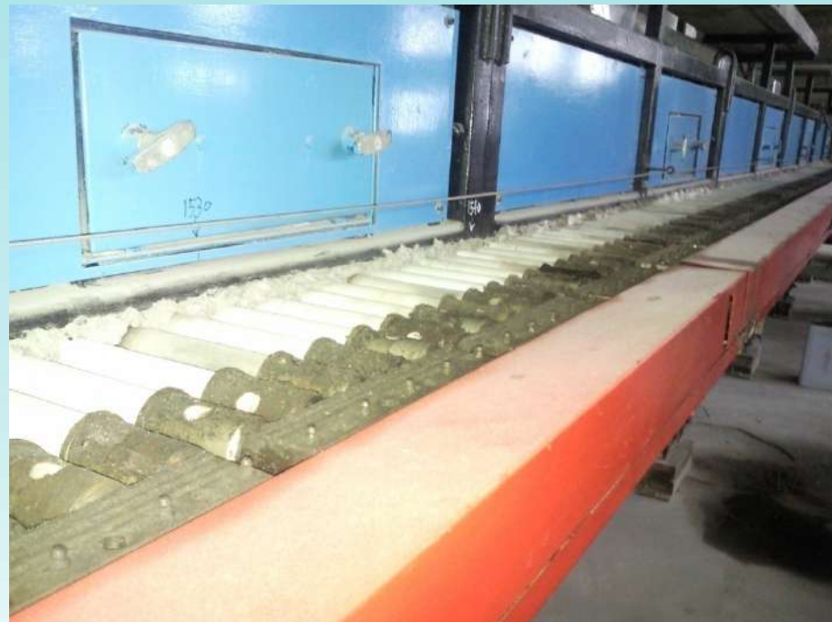
齒輪捲夾點護罩已關閉
