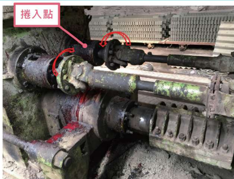
▲ 罹災者遭成型機運轉之傳動軸捲入。
