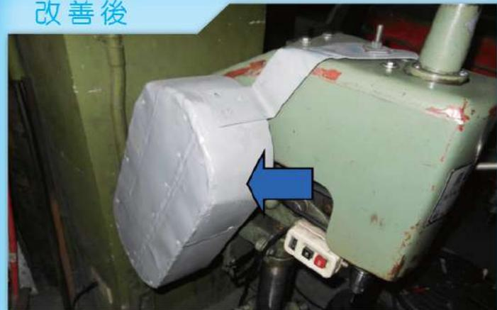
說明：攻牙機之傳動輪、傳動帶已設置護罩。
