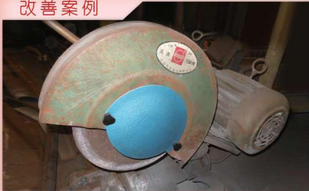
說明：切割用研磨機拆卸側研磨輪軸之側面已設覆蓋。（機械設備器具安全標準第97條）
