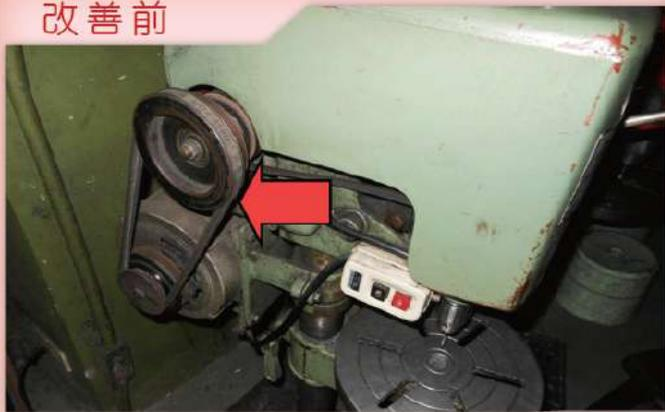
說明：對於機械之原動機、轉軸、齒輪、帶輪、飛輪、傳動輪、傳動帶等有危害勞工之虞之部分，應有護罩、護圍、套胴、跨橋等設備。
