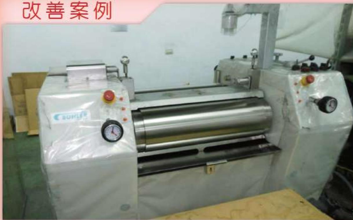
說明：滾輾機已設置易於操縱之緊急制動裝置。（職業安全衛生設施規則第79條）
