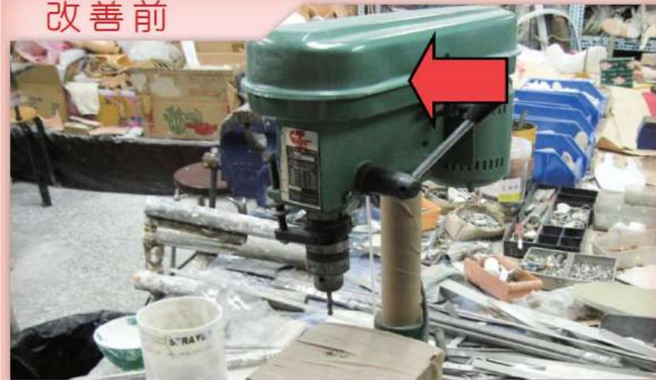
說明：對於鑽孔機、截角機等旋轉刀具作業，勞工手指有觸及之虞者，應明確告知並標示勞工不得使用手套。（職業安全衛生設施規則第56條）
