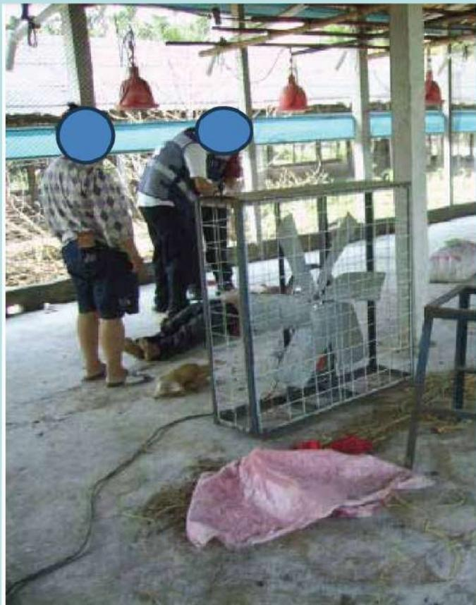
直接原因：頭部被傾倒工業風扇捲入
