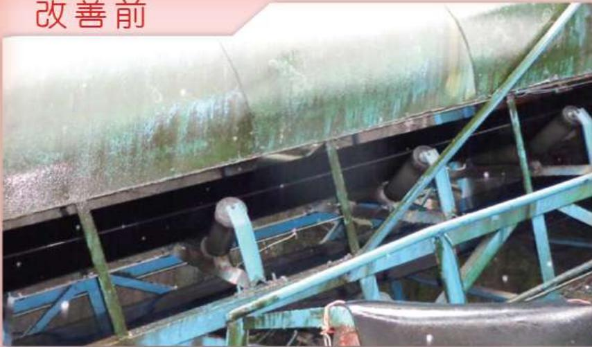
說明：輸送帶應於適當位置設置緊急制動裝置，立即遮斷動力並與剎車系統連動，於緊急時能立即停止原動機或動力傳動裝置之轉動。（職業安全衛生設施規則第48條）。
