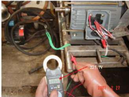
圖 11 馬達外殼沒有接地時，測量馬達外殼對遠處路燈燈桿（當作參考位準）間之電壓為 225.7V
