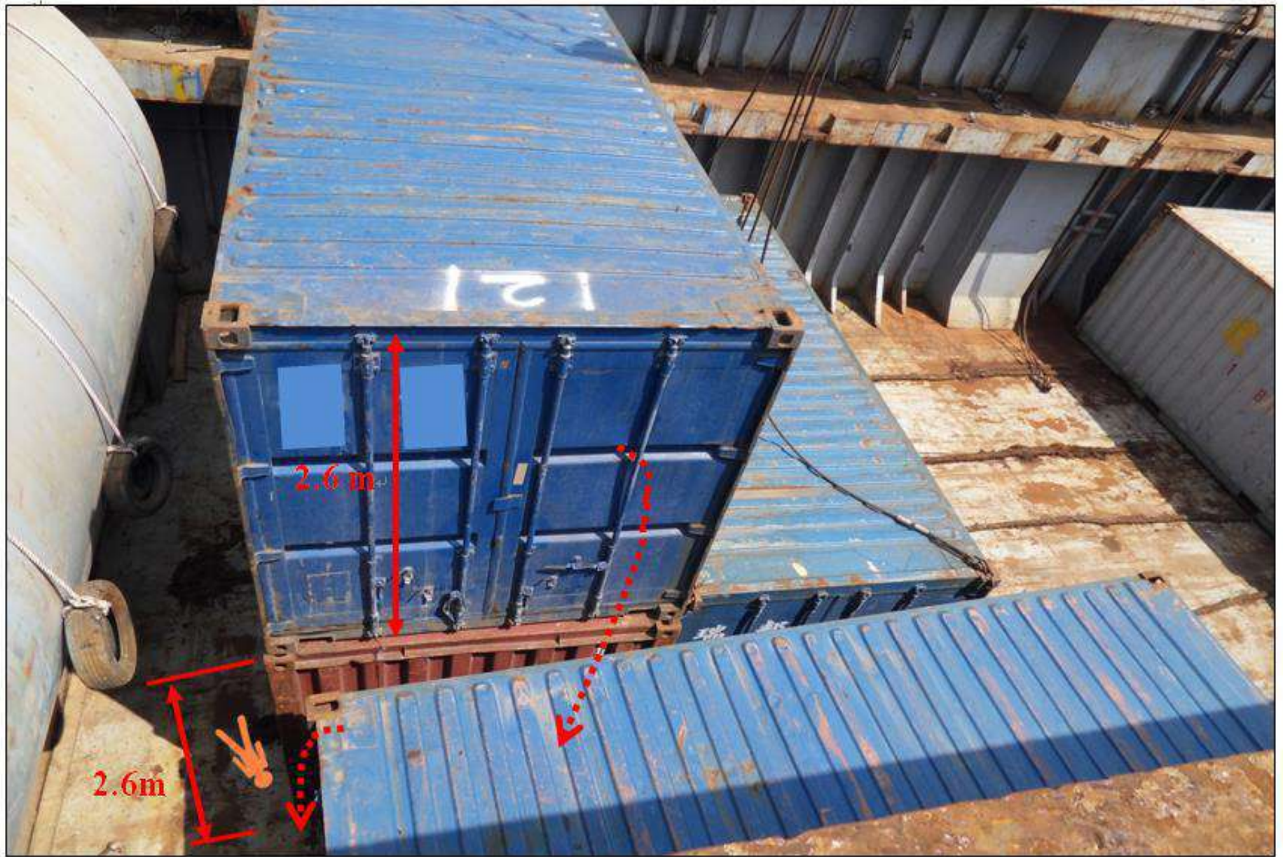
照片 2 罹災者跌落至船艙底之路徑及位置圖(示意圖)。
