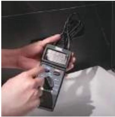
圖 8-7 選擇所需的測試電流，使用“旋轉開關測試電流檔位”（30mA）
