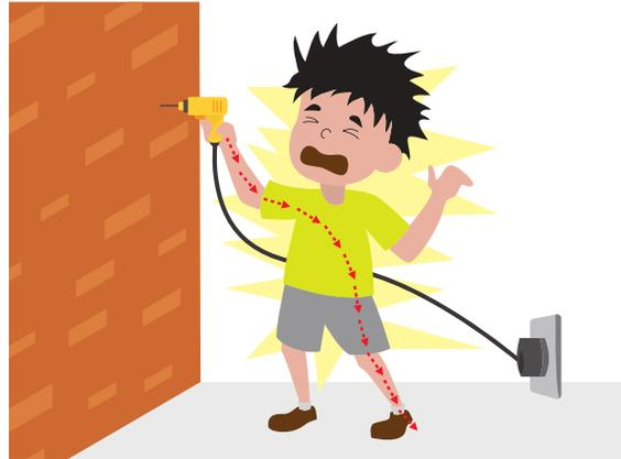
圖 2-4 感電發生時電流通過身體連接至大地
