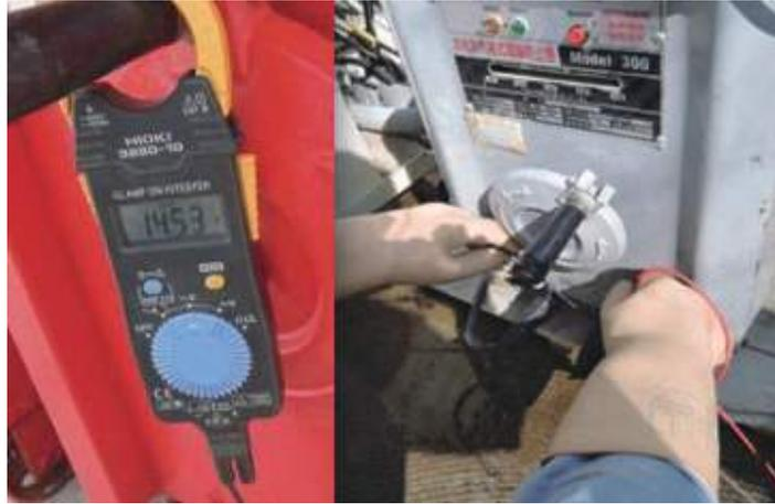
圖 8-17 電焊機自動防電擊功能檢測參考圖
