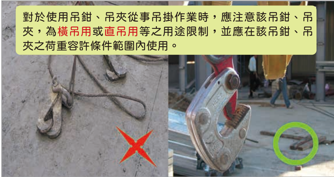
圖 5 吊鉗、吊夾使用
