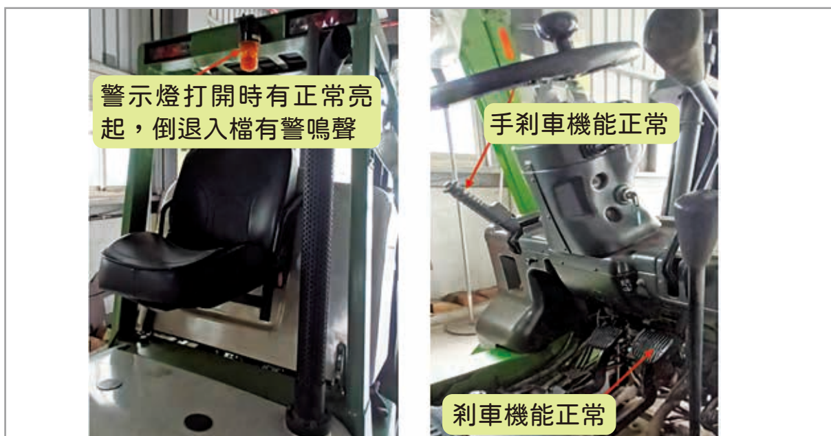
圖 48 堆高機檢查項目 -2
