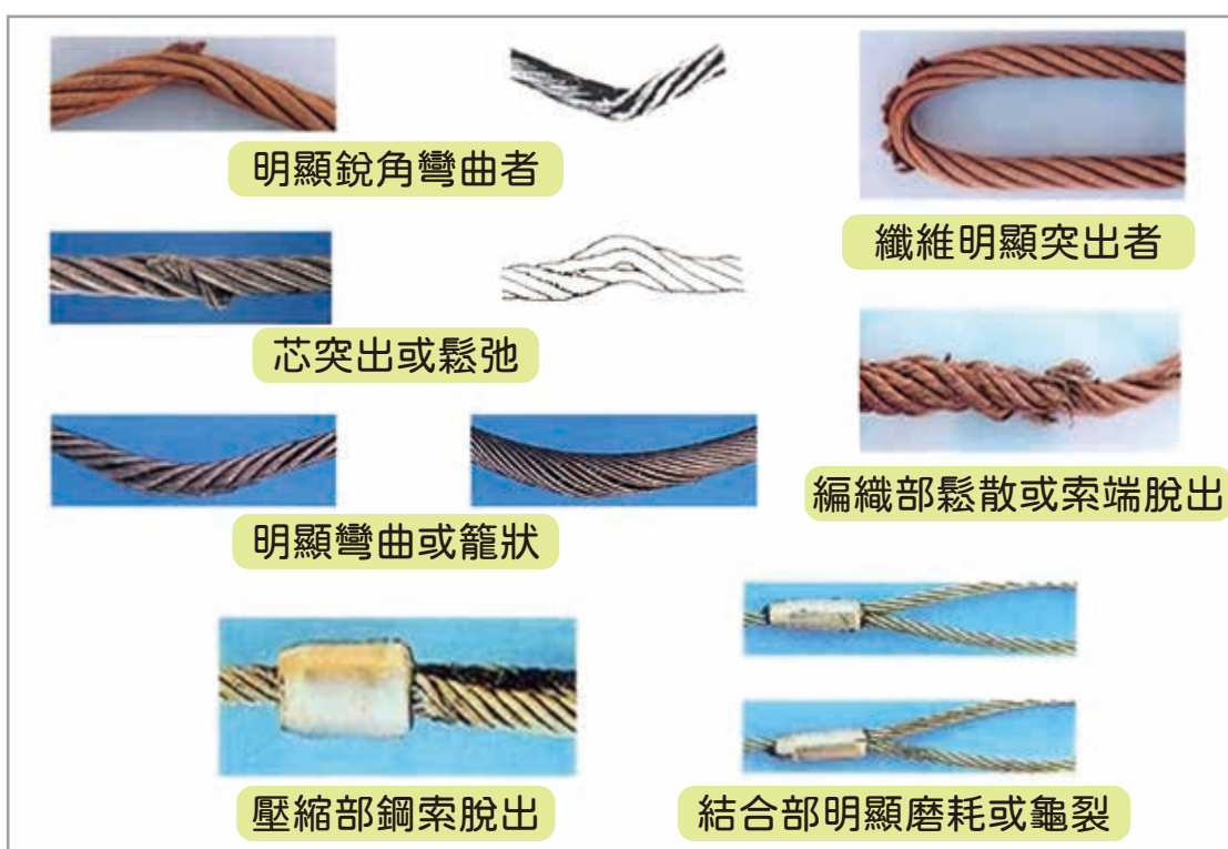
圖 8 鋼索損壞範例
