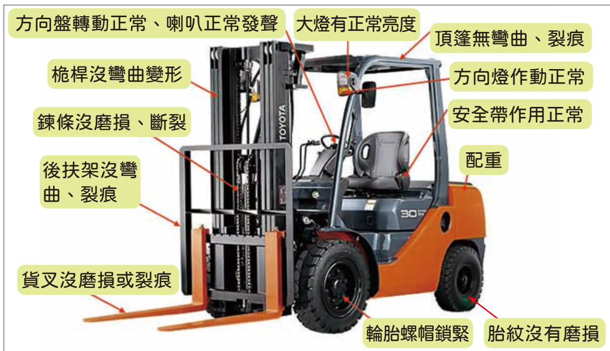
圖 47 堆高機檢查項目 -1
