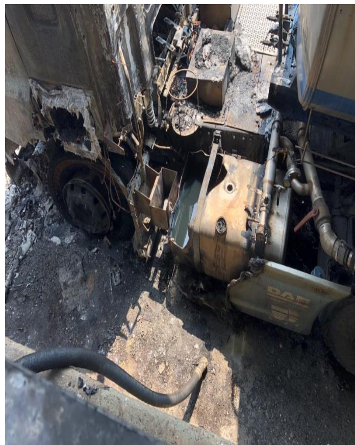
起火引起火災處(槽車引擎)
