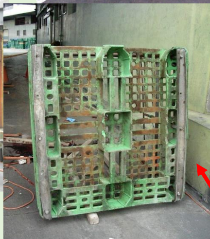
塑膠棧板底板破損
