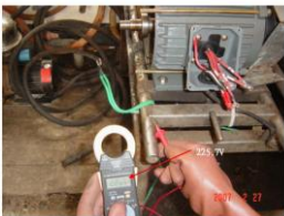
圖 11 馬達外殼沒有接地時，測量馬達外殼對造成路燈燈桿（當作參考位準）間之電壓為 225.7V
