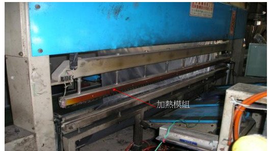
包裝機後緣之加熱模組漏電
