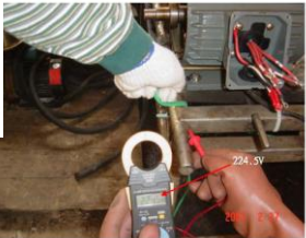
圖 12 馬達外殼有接地時，測量馬達外殼對造成路燈燈桿（當作參考位準）間之電壓為 224.5V
