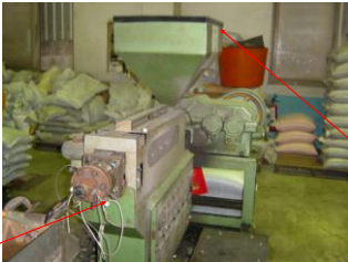
塑膠押出機漏電之感電職災
