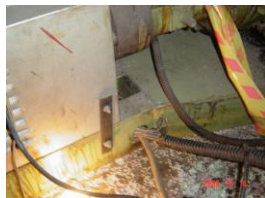
機台電源線出入口破皮感電事故
