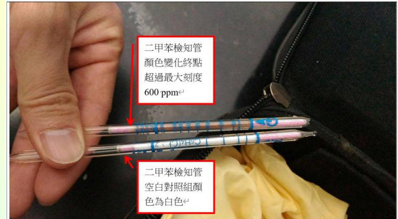
說明 照片 8、肇災後以檢知管量測地下水池內部空氣中所含二甲苯濃度之情形(檢知管顯示濃度已破出)。
