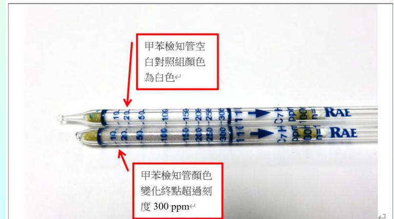
說明 照片 9、肇災後以檢知管量測地下水池內部空氣中所含甲苯濃度之情形(檢知管顯示濃度已破出)。
