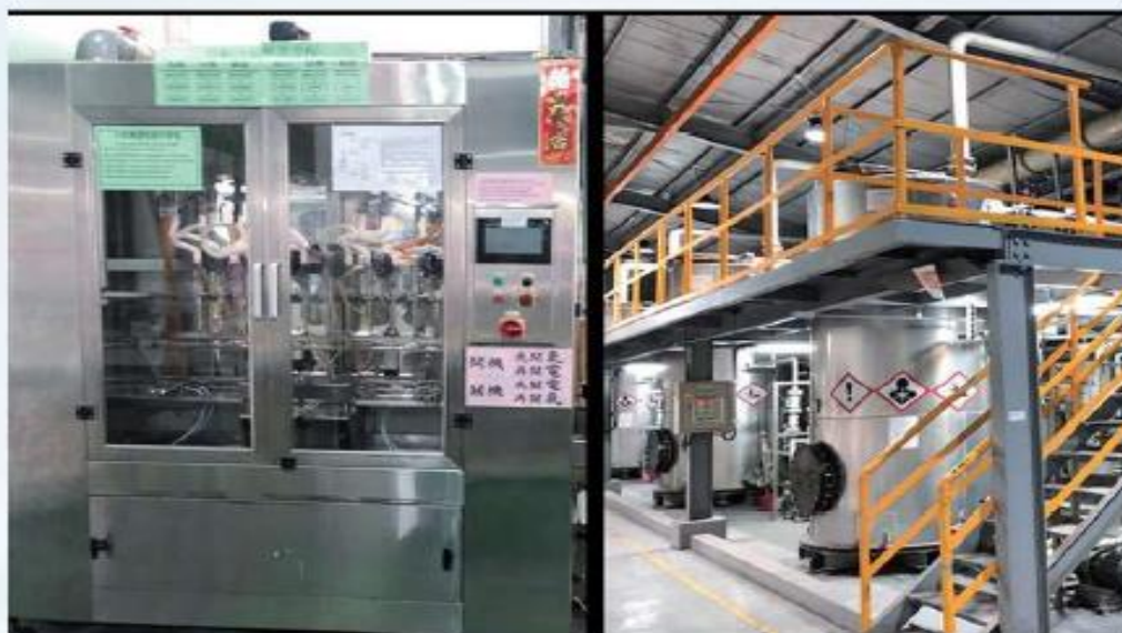
採用密閉隔離之控制措施範例
