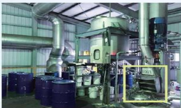
於化學品發生散布源設置局部排氣裝置
