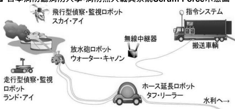
□ 日本消防廳消防大學-消防無人載具系統Scrum Force示意圖
