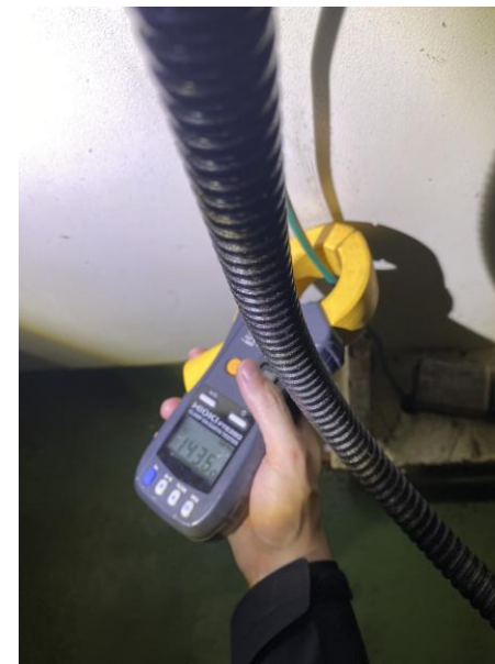
設備端金屬外殼接地
